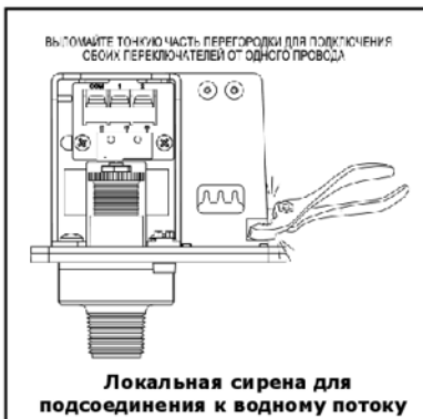
Подключение контактов для получения сигнала наличия давления
