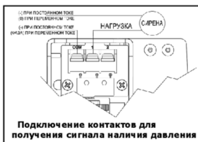
Подключение контактов для получения сигнала наличия давления
