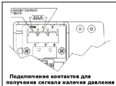
Подключение контактов для получения сигнала низкого давления
