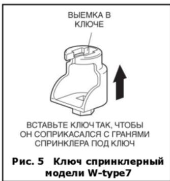
Рис. 5 Ключ спринклерный модели W-type7
