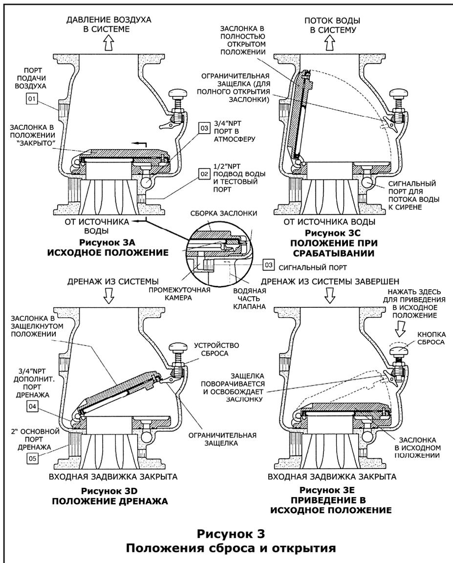
**Шаг 7:** Поднимите давление воздуха в системе приблизительно до 1,4 бар (20 psi), индивидуально откройте все дополнительные дренажи в трубопроводе системы, чтобы слить воду, оставшуюся в сработавших секциях. Закройте каждый дренажный вентиль, как только слив воды прекратится. Частично откройте нижний дренажный вентиль (рис. 5), чтобы убедиться в отсутствии воды в клапане.
