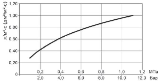
**Рис. 5б Для оросителей модели TY5151 (тип ELO-231) с вогнутой розеткой (ГОСТ Р 51043-2002)
