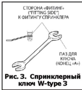
**Рис. 3. Спринклерный ключ W-type 3**
