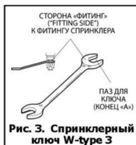
**Рис. 3. Спринклерный ключ W-type 3**
