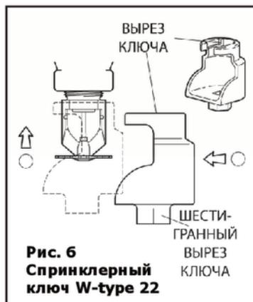
**Рис. 6 Спринклерный ключ W-тире 22**
