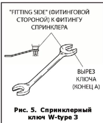
**Рис. 5. Спринклерный ключ W-тире 3**
